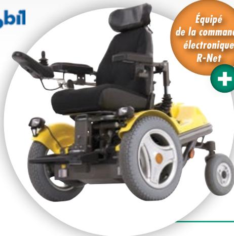
Équipé de la commande électronique R-Net
